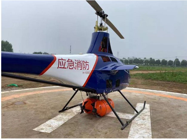
▲无人机集群协同灭火系统中的无人机与团队研发的新型灭火弹
